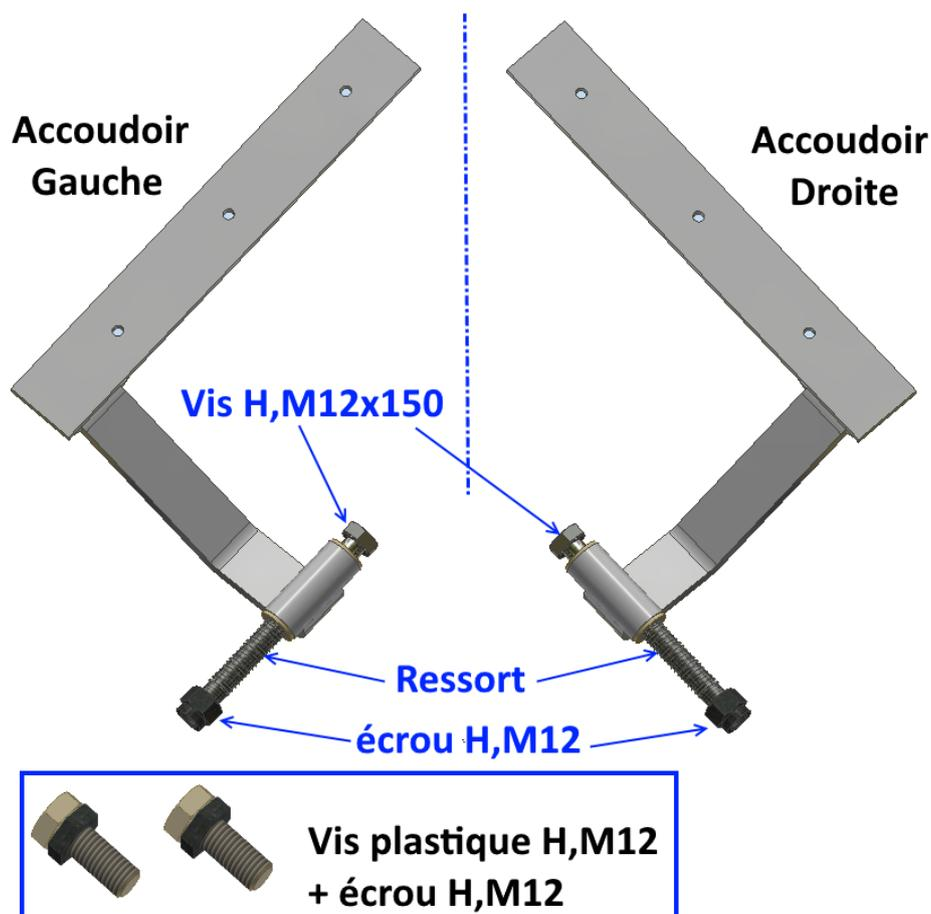
1/ Positionner de chaque côté la vis plastique TH M10 + écrou plat H,M10
